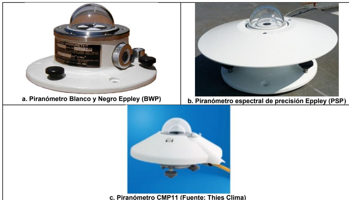
**Figura 3. Piranómetros.** Fuente: Tomado de IDEAM, (IDEAM, 2018)
