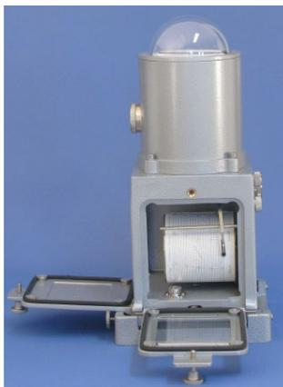
**Figura 6.** Actinógrafo bimetalico, tipo Robitzsch-Fuess 58dc
