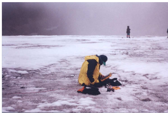
Figura 19. Radar de impulso para determinar espesores de hielo
