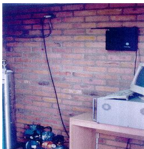
Figura No. 6 Gas de calibración y analizador OPSIS - Estación Hospital Olaya
