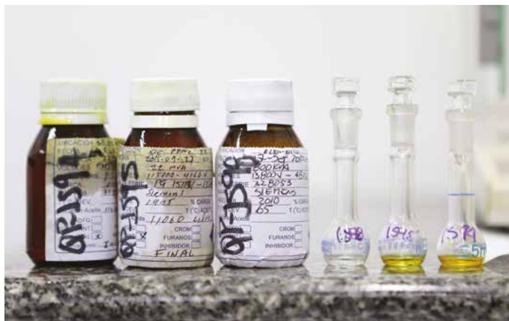
◀ Muestras de aceites dieléctricos con diferentes concentraciones de PCB.
