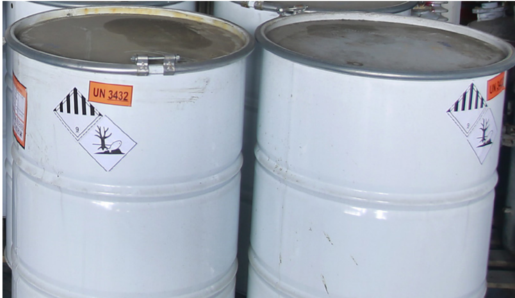
◀ Rotulado de contenedor de residuos sólidos contaminados con PCB
