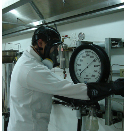
◀ Reactor de oxidación de PCB en agua supercrítica
